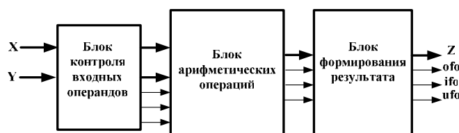
Рис. 5.4. Обобщенная структурная схема функциональных узлов с плавающей запятой
