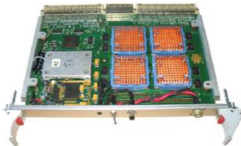
Рис. 4.22. Базовый модуль 4V2P-32 с радиаторами на ПЛИС Virtex II Pro XC2VP100
