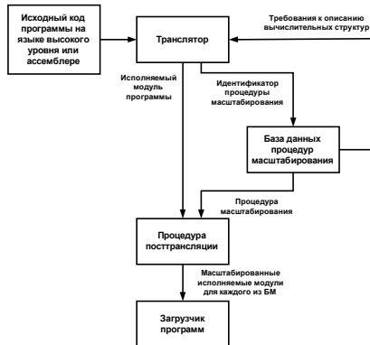
Рисунок 1 – Структура системы посттрансляции
