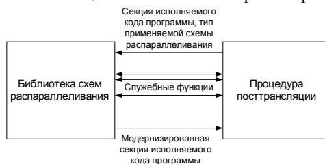
Рисунок 2 – Схема взаимодействия библиотеки схем распараллеливания и процедуры посттрансляции
