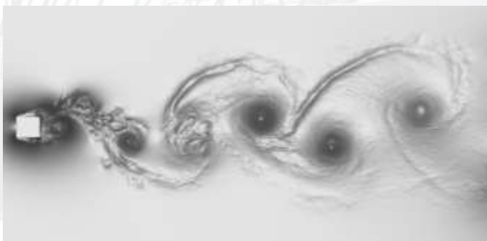
Турбулентный след за цилиндром (дорожка Кармана)
