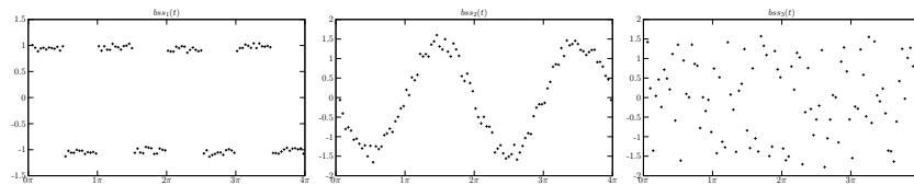
Рис. 4. Три сигнала с модуляцией типа qpsk
