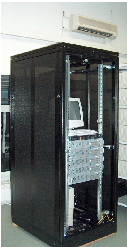
Рис. 3.1. Пример стойки с пятью узлами и монитором
