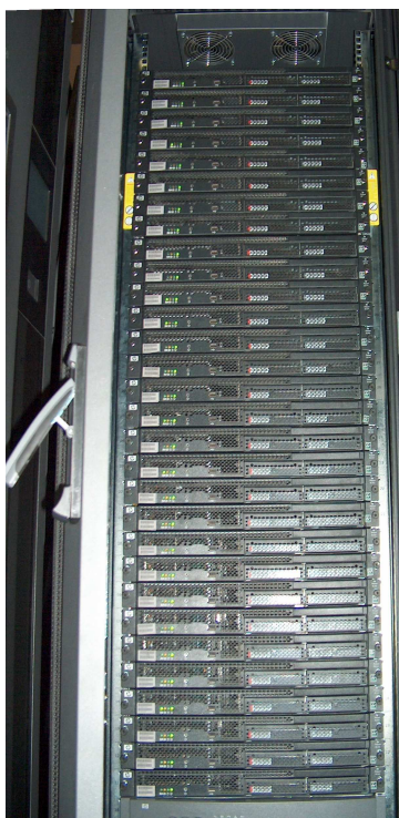
Рис. 3.2. Пример стойки с 30 узлами формата 1 U
