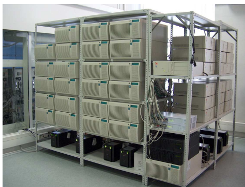
Рис. 3.3. Пример расположения кластера из 16 узлов на стеллажах
