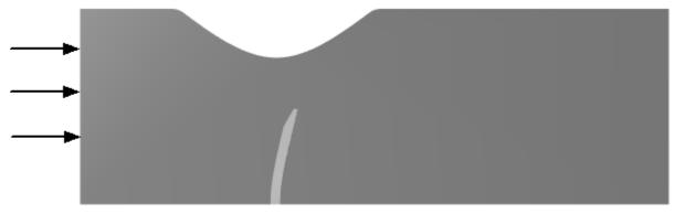
Моделируется течение в двумерном канале, частично перекрытом деформируемым клапаном. Деформация клапана моделируется в Abaqus.
